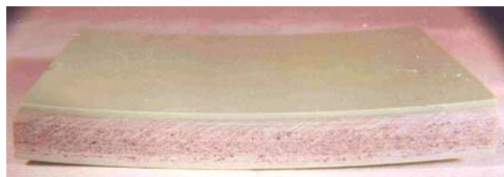
Abb.1 Sandwichlaminat mit Balsaholzkern
