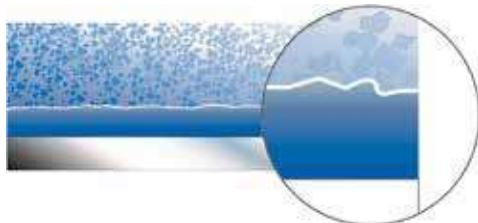
Eine Politur wirkt wie ein flüssiges Schleifpapier. Das in einer Politur enthaltene Polierkorn greift mechanisch in die Oberfläche ein. Dabei werden Unebenheiten, Furchen und Riefen abgetragen und ausgeglichen. Die mikroporöse Oberfläche wird durch die Schleifpartikel in der Politur „glatt geschliffen“ - quasi verfeinert und erhält ihren ursprünglichen Hochglanz zurück.
