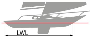
$$\text{LWL} \times (\text{B} + \text{T}) \times 0,50 = \text{Unterwasserbereich}$$
