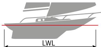
$$\text{LWL} \times (\text{B} + \text{T}) \times 0,75 = \text{Unterwasserbereich}$$
