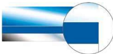
Je nach Zustand der Oberfläche gibt es Schleif- und Polierpasten und Polituren in unterschiedlichen „Körnungen“ und sie tragen daher unterschiedlich stark Material ab. Wenn Sie sich nicht sicher sind, welche Stärke an Politur sie benötigen, tasten Sie sich allmählich an die erforderliche Schleifwirkung heran. Handeln Sie nicht nach dem Motto „Viel hilft auch viel“!
