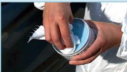
Zur Langzeitkonservierung des Gelcoats wird zu guter Letzt **BOAT WAX** (oder ähnlich geeignete Versiegelungen wie z. B. **REFINISH PREMIUM GLOSS**) verwendet, um die Fläche vor UV-Licht zu schützen und unempfindlicher gegen Verschmutzung zu machen. Das Wachs wird dünn mit einem Lappen aufgetragen. Nach einer Abluftzeit von ca. 20 Minuten wird die Fläche mit einem fusselfreiem Lappen manuell auf Hochglanz poliert. Nach 2 Stunden kann ggf. ein zweiter Wachsauftrag vorgenommen werden.
