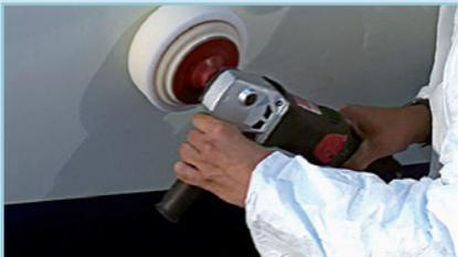
Für ein hochglänzendes Endergebnis verwendet man die Schleif- und Polierpaste **REFINISH ONE**. Die Polierpaste wird gleichmäßig auf die zu polierende Fläche aufgetragen und mit der Hand oder besser mit einer Poliermaschine und dem **POLISHING PAD** (Schaumteller) aufpoliert. Die Poliermaschine sollte maximal eine Umdrehung von U/Min. aufweisen, um durch die Wärmeentwicklung das Gelcoat nicht zu schädigen.
