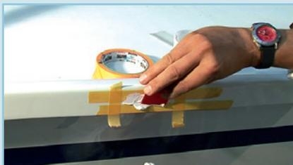
Nach dieser gründlichen Vorbereitung wird die benötigte Menge Gelcoat aus dem Gebinde entnommen und im Mischbecher (Haube des Sets) mit dem CHP-Härter vermischt. Gelcoat und Härter werden sorgfältig miteinander vermischt. Bei der Vermischung ist darauf zu achten, dass der Härter vollständig untergerührt wird. Die Masse langsam verrühren, damit keine Luftblasen eingerührt werden. Danach wird die thixotrope Masse in die Schadensstelle mit einem Spachtel oder Pinsel eingebracht und glattgestrichen.
