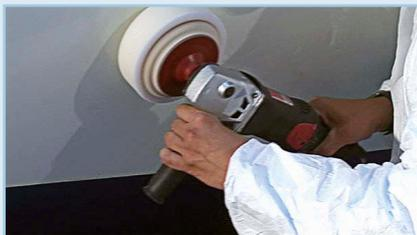
Für ein hochglänzendes Endergebnis verwendet man die Schleif- und Polierpaste **REFINISH ONE**. Die Polierpaste wird gleichmäßig auf die zu polierende Fläche aufgetragen und mit der Hand oder besser mit einer Poliermaschine und dem **POLISHING PAD** (Schaumteller) aufpoliert. Die Poliermaschine sollte maximal eine Umdrehung von U/Min. aufweisen, um durch die Wärmeentwicklung das Gelcoat nicht zu schädigen.
